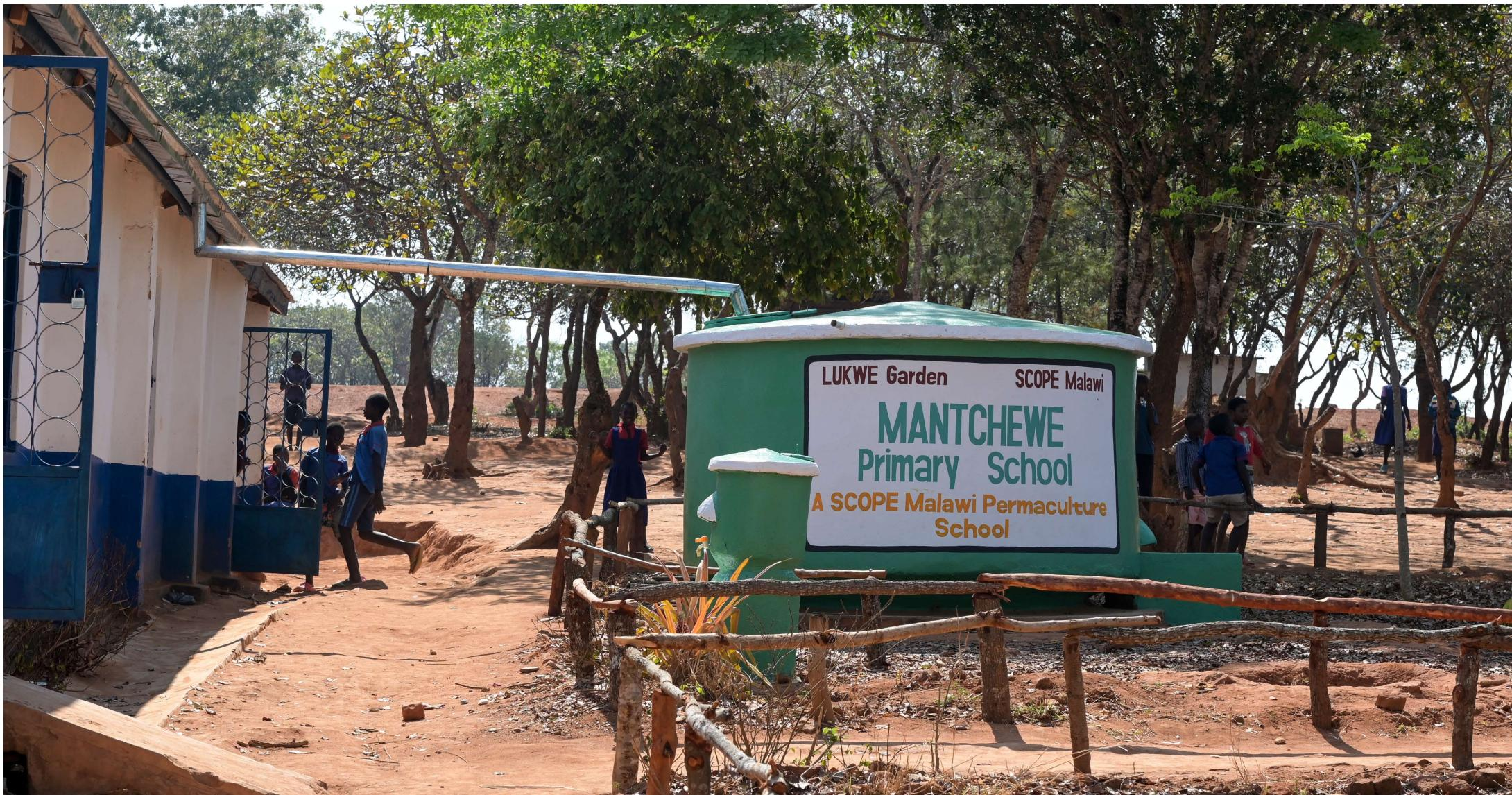
Für die Bewässerung in der Trockenzeit hat SCOPE einen 10.000 Liter fassenden Tank gebaut, der den Regen vom Schuldach sammelt. Ein zweiter, 55.000 Liter großer Tank ist in Bau.
