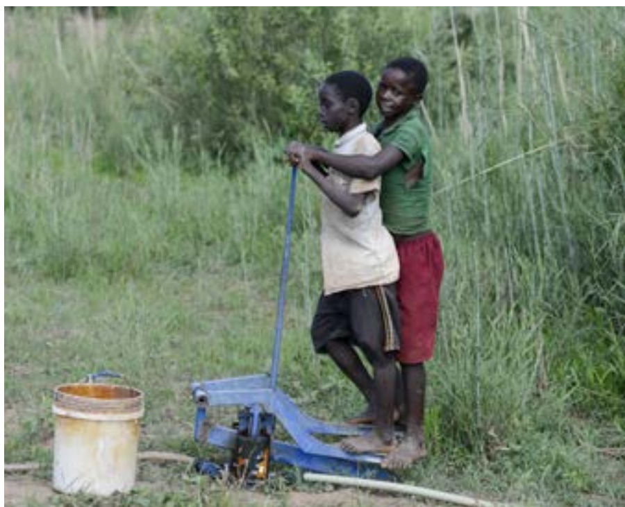
Jackson Hanzala (14 Jahre, rechts) und sein Freund bewässern ein Gemüsefeld mit einer Tretpumpe.
