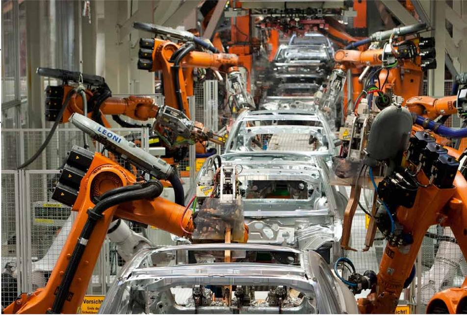
**Industrieroboter fertigen im Audi-Werk Ingolstadt Karosserien. Die Bleche für den Karosseriebau kommen bei allen Autokonzernen von Zulieferern.**
