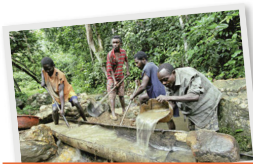
Kongo Durch die ständige Zufuhr von Wasser trennt sich der Abraum vom spezifisch schwereren Coltan.
